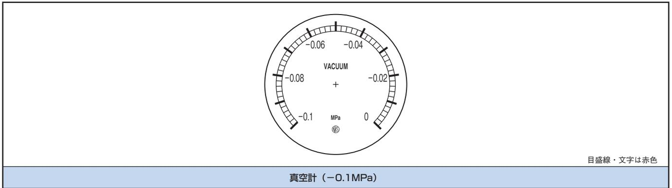
JIS1.6級目盛図（普通形圧力計、密閉形圧力計）【連成計】
