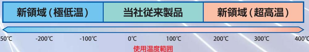
使用温度範囲を大幅に拡大、極限環境での圧力計測を可能。
