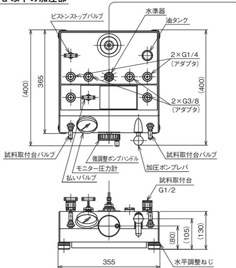
最大測定圧力 50MPa 以上の加圧部
