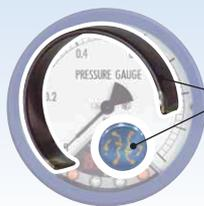
アナログ指示部用のブルドン管と半導体蒸着形 (SS) センサの両方を内蔵
